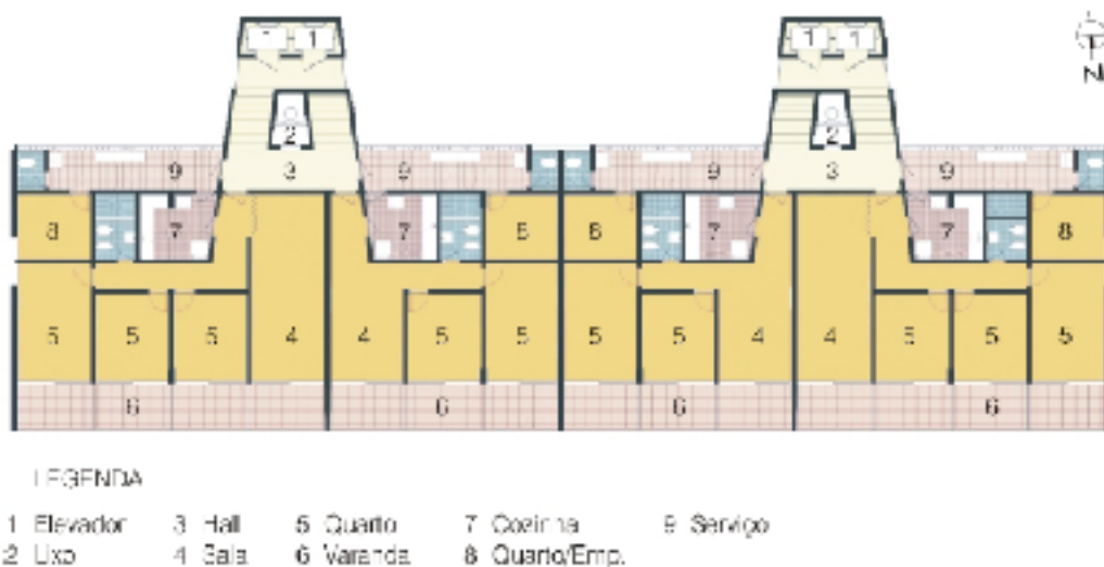
Figura 05 – Planta do Pavimento Tipo. Fonte: Fúlvio Pereira, 2008.
