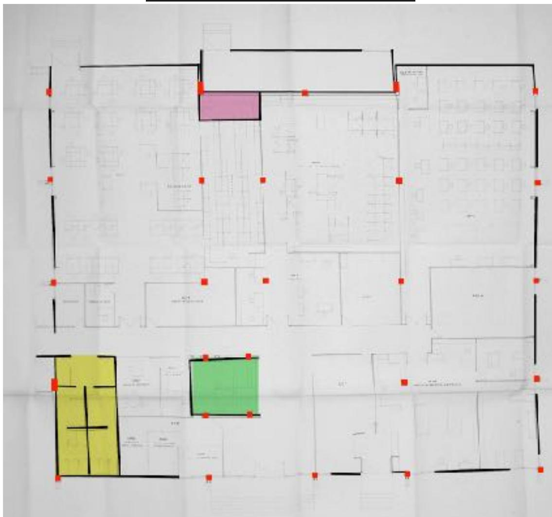
Figure 15 - Planta de layout com indicações de pilares e alvenaria, 1982.
