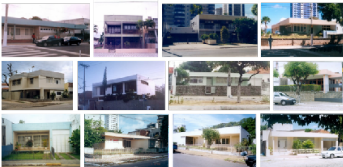
Figura 8: Exemplos que demonstram a utilização da “platibanda-beiral” no grupo. Fonte: Imagem elaborada pela autora a partir de fotografias disponibilizadas pelo Acervo MUsA.
