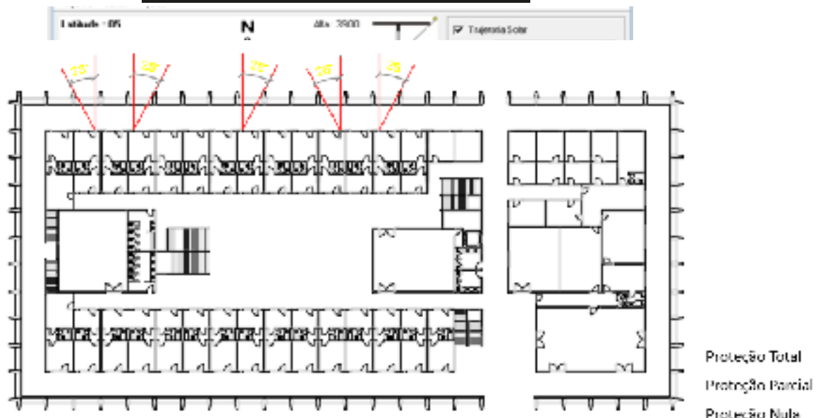
Figura 8 – Lateral Oeste com \beta = 28^\circ Fonte: Planta Baixa por Negreiros (2010), utilizada na análise de insolação nas fachadas.
